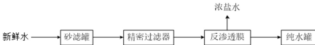
图 2-2 软水处理工艺流程图
