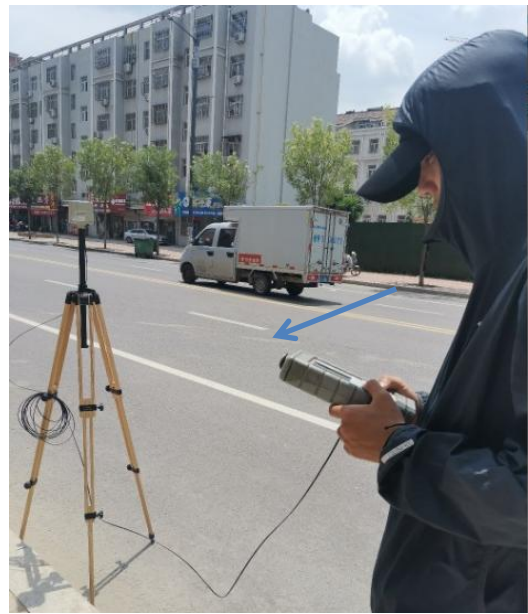
1.线路测点 B1, 110KV 双回电缆线路 大安街南进线向北侧衰减
