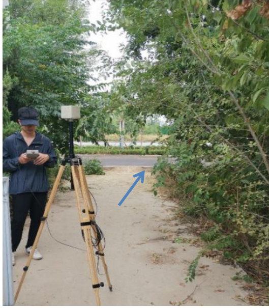
5.线路测点 B5, 110KV 双回电缆线路 武阳街向南侧衰减
