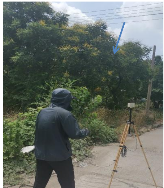
4.线路测点 B4, 110KV 双回架空线路 雷鸿线燕塔支线 24#-25#塔导线东侧 衰减
